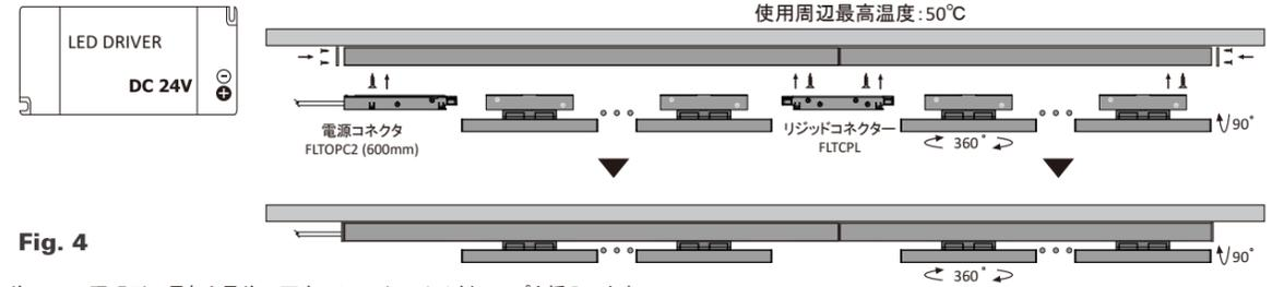
表面のネジで押し出しを固定した後、1つの照明列の最初と最後の両方のトラックにサイドキャップを挿入します。LEDトラック照明器具の固定は、その中の磁気とロッカーを介して行われます。これらは、磁気とロッカーで目的の場所に固定する必要があります。その後、LEDトラック照明器具を所定の位置に固定することができます。
