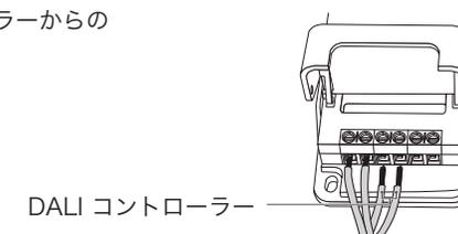
4 配線図に示すように、LED モジュールを出力方向に接続します。
