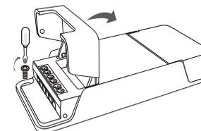
2 配線図に示すように、DC 電源を入力方向に接続します。
