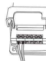
3 配線図に示すように、DALI コントローラーからの信号線を接続します。
