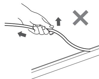
⚠️ 設置した器具を引っ張り上げたり、引き寄せたりしないでください。断線や接点不良により不点灯や火災、感電、故障の原因になります。
